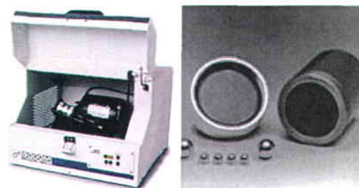
Figure IV.3. Broyeur SPEX 8000 et creusets et billes en acier inoxydable utilisés dans cette thèse.
